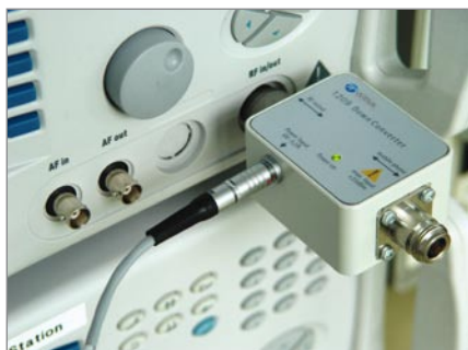
Figura 2: El 1209 Downconverter es una extensión de frecuencia opcional para realizar pruebas Bluetooth, WLAN, GPS y para los estándares de TV móvil.
